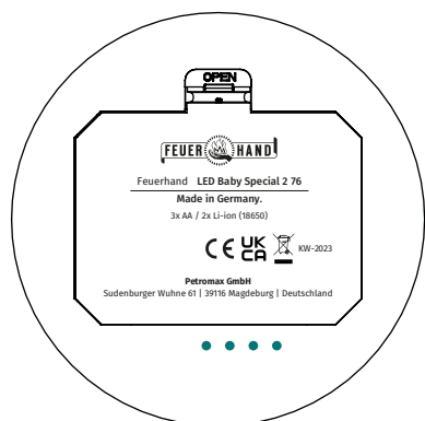
Fig. 1.3 : Vano batterie chiuso con indicatore di carica per un massimo di 5 secondi dopo la messa in servizio
